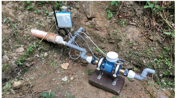
Messung einer Quellschüttung mit batteriebetriebenen Promag W 800
