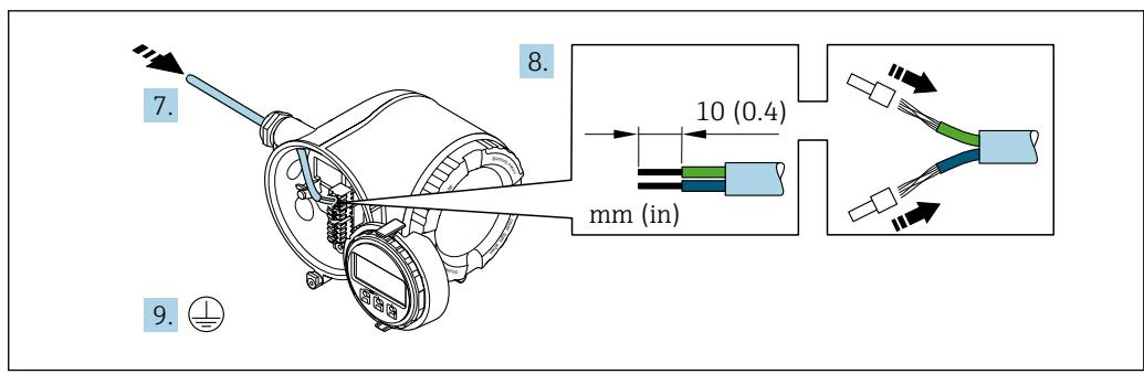
7. Empurre o cabo através da entrada para cabo. Para assegurar total vedação, não remova o anel de vedação da entrada para cabo.
