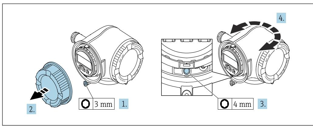
1. Dependendo da versão do equipamento: Solte a braçadeira de fixação da tampa do compartimento de conexão.
