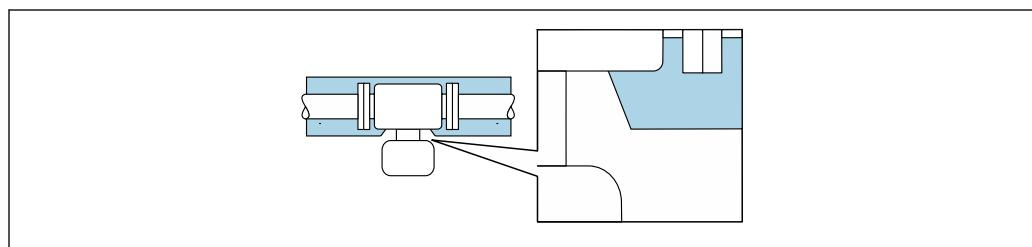
Fig. 7 Isolamento térmico com pescoço estendido livre
