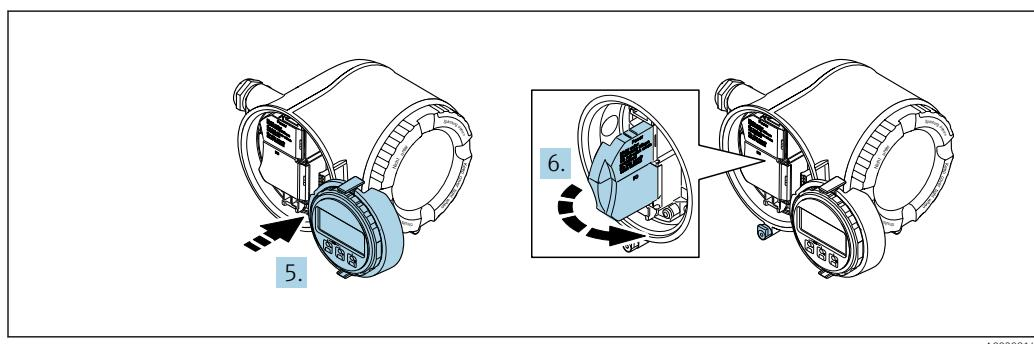
5. Instale o suporte à borda do compartimento de componentes eletrônicos.
