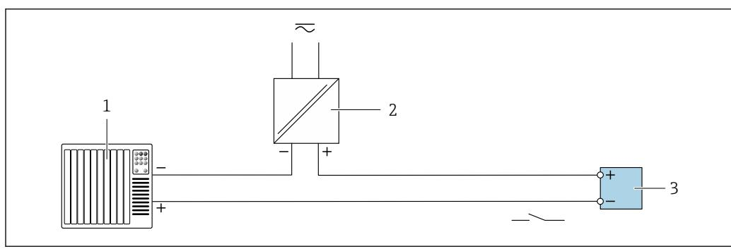
■ 21 Exemplo de conexão para saída comutada (passiva)
