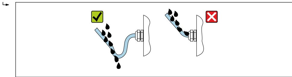
6. Insira conectores falsos nas entradas para cabo não usadas.
