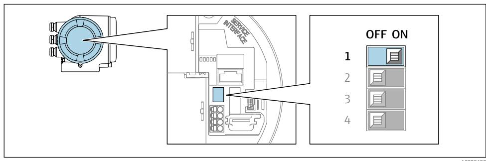
O ajuste da chave de proteção contra gravação (WP) no módulo de eletrônica principal para a posição **ON** habilita a proteção contra gravação de hardware.
