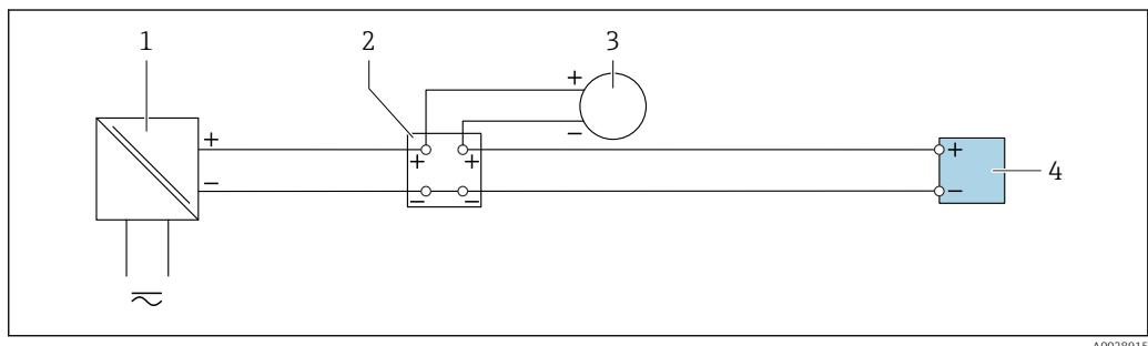
Fig. 23 Exemplo de conexão para entrada em corrente de 4 a 20 mA
