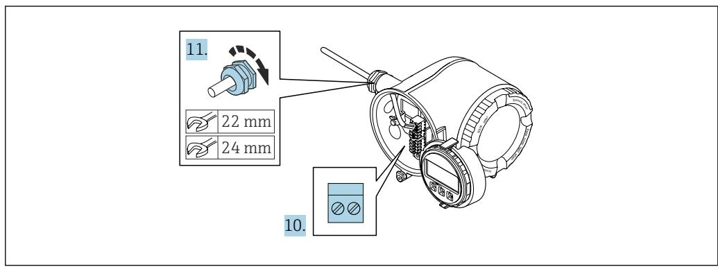
10. Conecte o cabo de acordo com o esquema de ligação elétrica .
