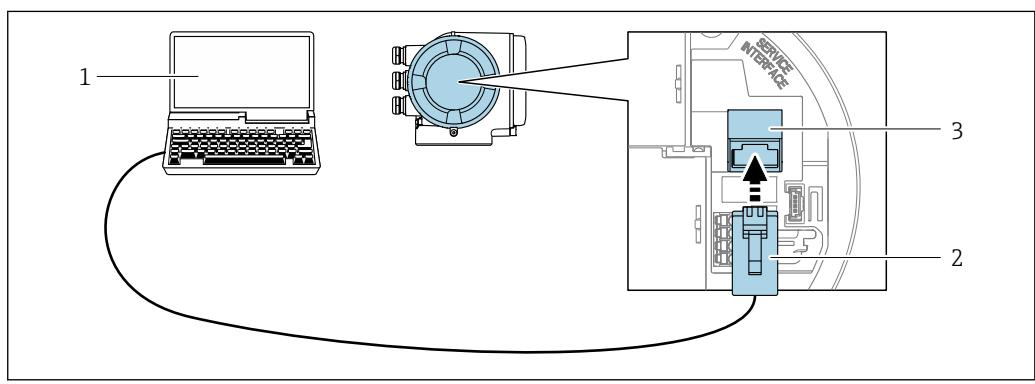
**■ 31 Conexão através de Interface de operação (CDI-RJ45)**
