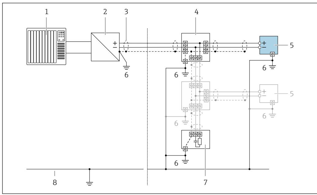
14 Exemplo de conexão para FOUNDATION Fieldbus
