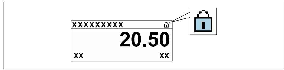
2. O ajuste da chave de Proteção (WP) contra gravação no módulo de eletrônica principal para a posição **OFF** (ajuste de fábrica) desabilita a proteção contra gravação de hardware.
