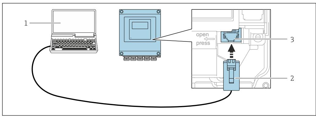
**■ 30 Conexão através de Interface de operação (CDI-RJ45)**
