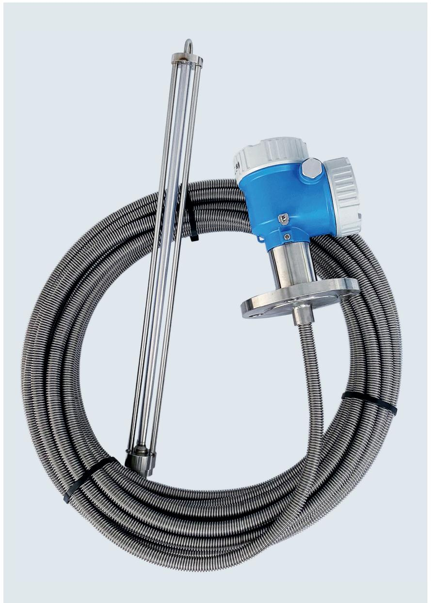
La justesse de la température moyenne est cruciale pour le suivi précis des stocks et la transaction commerciale, car elle a un impact direct sur le volume. Des facteurs externes comme l'ensoleillement, la géométrie du réservoir ou le fonctionnement entraînent une stratification de la température. C'est pourquoi il est nécessaire d'utiliser une sonde de température multipoint.
