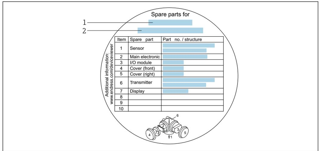
図 28 端子部カバーの「スペアパーツ概要ラベル」の例
