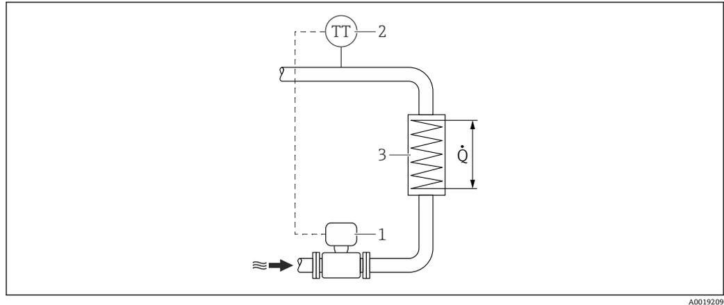
図 9 飽和蒸気/水の差エネルギー計測
