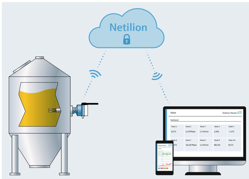
Le capteur de fermentation envoie les valeurs mesurées dans un cloud sécurisé, où elles sont transformées en informations pertinentes par un algorithme.
