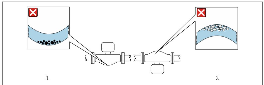
☒ 23 Orientamento del sensore con tubo di misura curvo
