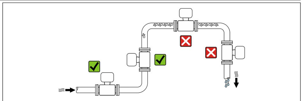
Per evitare errori di misura derivanti dall'accumulo di bolle di gas nel tubo di misura, evitare le seguenti posizioni di montaggio nella tubazione:
