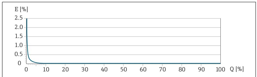
E Errore di misura massimo in % v.i. (esempio con PremiumCal)
