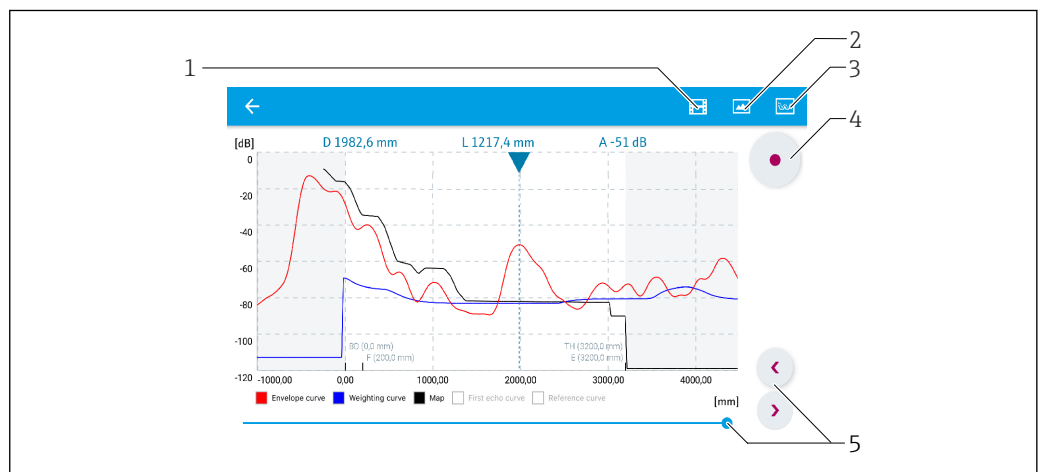
36 Zobrazenie obáľkovej krivky (príklad) v aplikácii SmartBlue; Zobrazenie v zariadeniach Android
