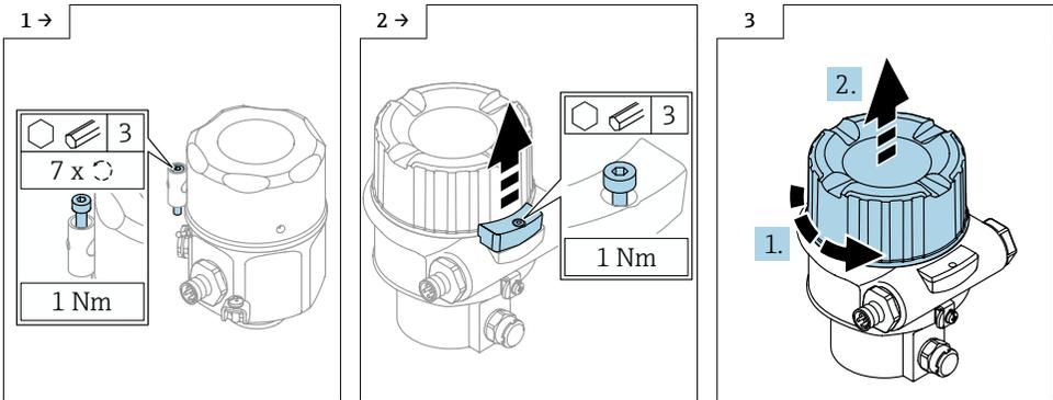
► Optional: Deckelsicherung bei F15 Gehäuse
