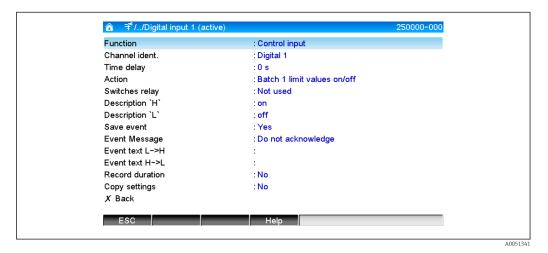
■ 5 Expert  $\rightarrow$  Inputs  $\rightarrow$  Digital inputs  $\rightarrow$  Digital input x
