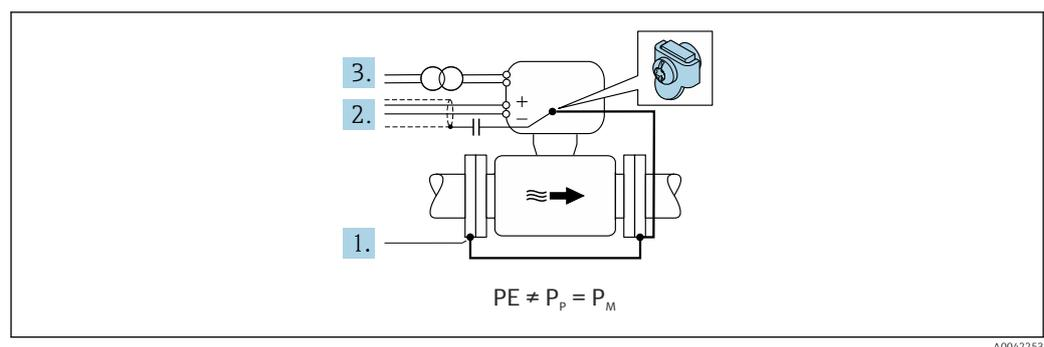
1. Collegare le flange della tubazione e il trasmettitore tramite il cavo di messa a terra.
