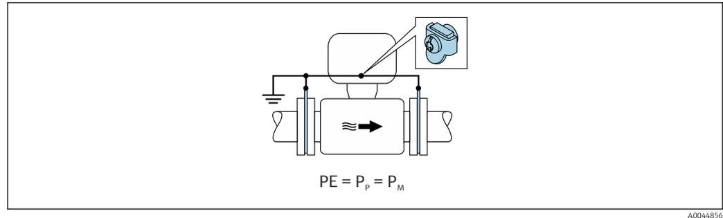
1. collegare i dischi di messa a terra al morsetto di terra del vano collegamenti del trasmettitore o del sensore mediante il cavo di messa a terra.
