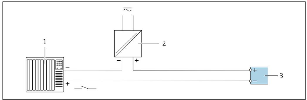
29 Esempio di connessione per ingresso di stato
