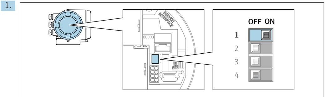
Impostando il microinterruttore di protezione scrittura (WP) sul modulo dell'elettronica principale in posizione **ON**, si attiva la protezione scrittura hardware.
