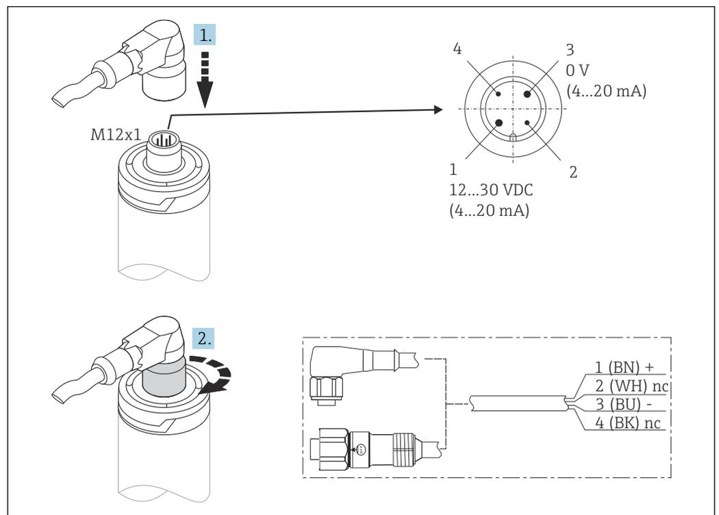
図 6 ケーブルプラグ M12x1 および機器の接続ソケットのピン配列
