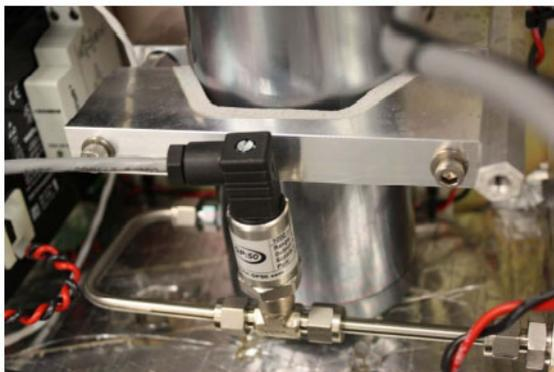
Figura 40. Novo sensor de pressão instalado
