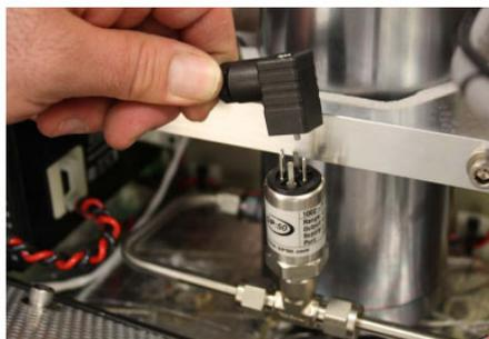
Figura 37. Remoção da tampa do chicote
