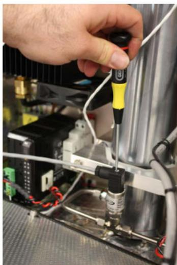
Figura 36. Remoção do parafuso da tampa do chicote
