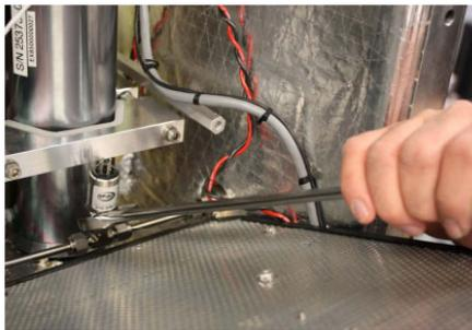
Figura 38. Remoção do sensor de pressão
