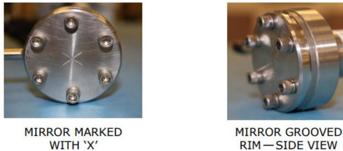
Figura 30. Marca no espelho de aço inoxidável
