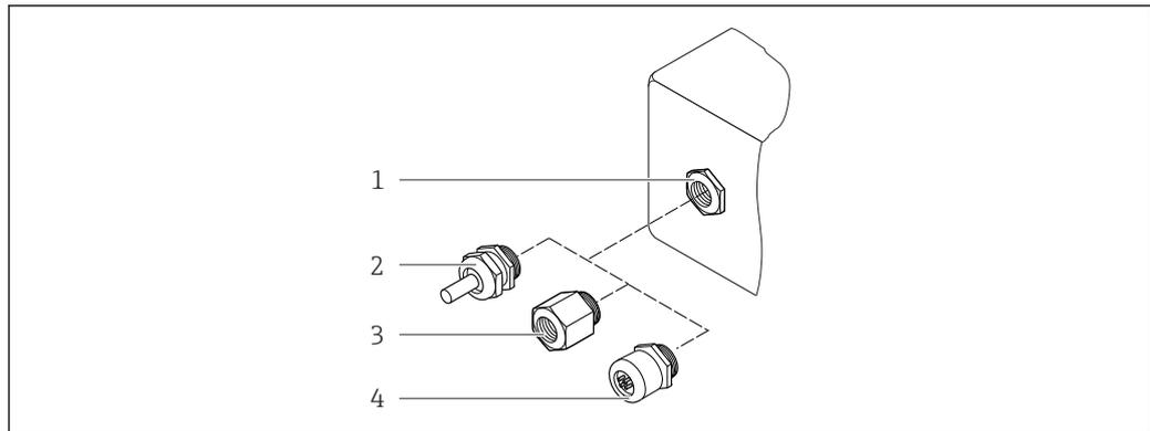
26 Mögliche Kabeleinführungen/-verschraubungen
