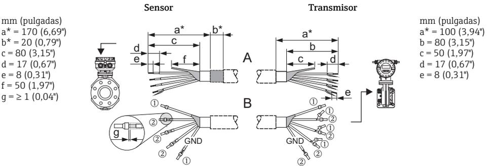
① = terminales de extremo del cable, rojo, Ø 1,0 mm (0,04"); ② = terminales de extremo del cable, blanco, Ø 0,5 mm (0,02")
