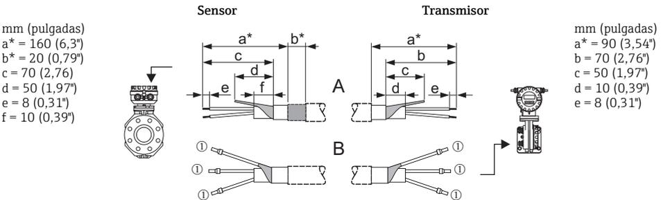
① = terminales de extremo del cable, rojo, Ø 1,0 mm (0,04"); ② = terminales de extremo del cable, blanco, Ø 0,5 mm (0,02")
