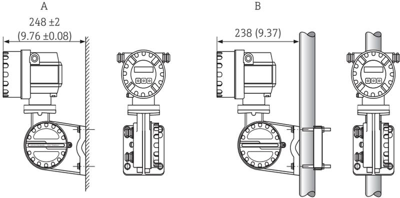
Fig. 1: Montaje del transmisor (versión remota). Unidad de ingeniería mm (pulgadas).
