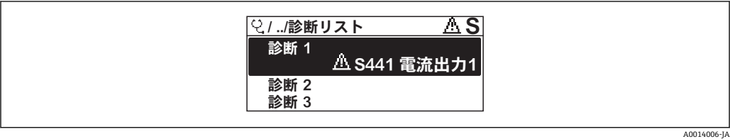
図 27 現場表示器の表示例
