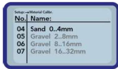
1. Utiliser les touches de navigation pour parcourir la liste et sélectionner l'étalonnage souhaité. Le symbole "!" placé devant un étalonnage indique l'étalonnage qui est actuellement actif.
