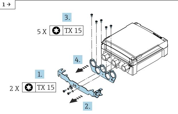
► Die 2 Torx Schrauben lösen und Antennenhalter wegnehmen. Die 5 Torx Schrauben lösen und das Conduit Adapter wegnehmen.
