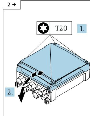
► Die 4 Torx Schrauben vom Deckel lösen und Deckel öffnen.
