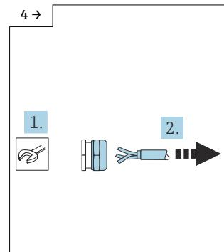
► Kabelverschraubung lösen.
