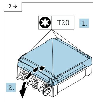
► Die Torx Schrauben vom Deckel lösen und Deckel öffnen.
