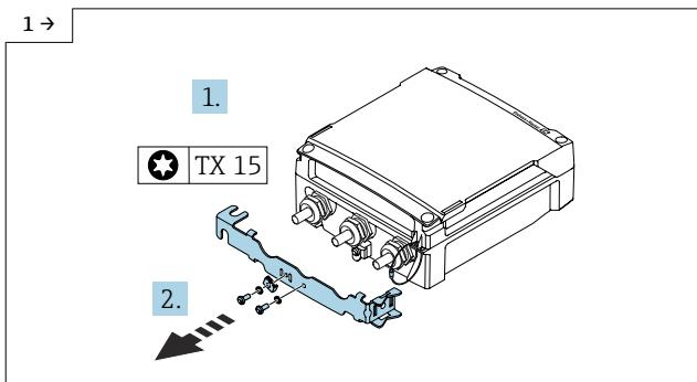
► Die Torx Schrauben lösen und Antennenhalter wegnehmen.
