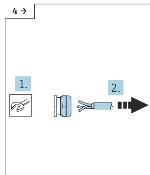
► Kabelverschraubung lösen.
