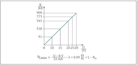
$R_{Lm\acute{a}x}$ Resistencia de carga máx. [ $\Omega$ ]
