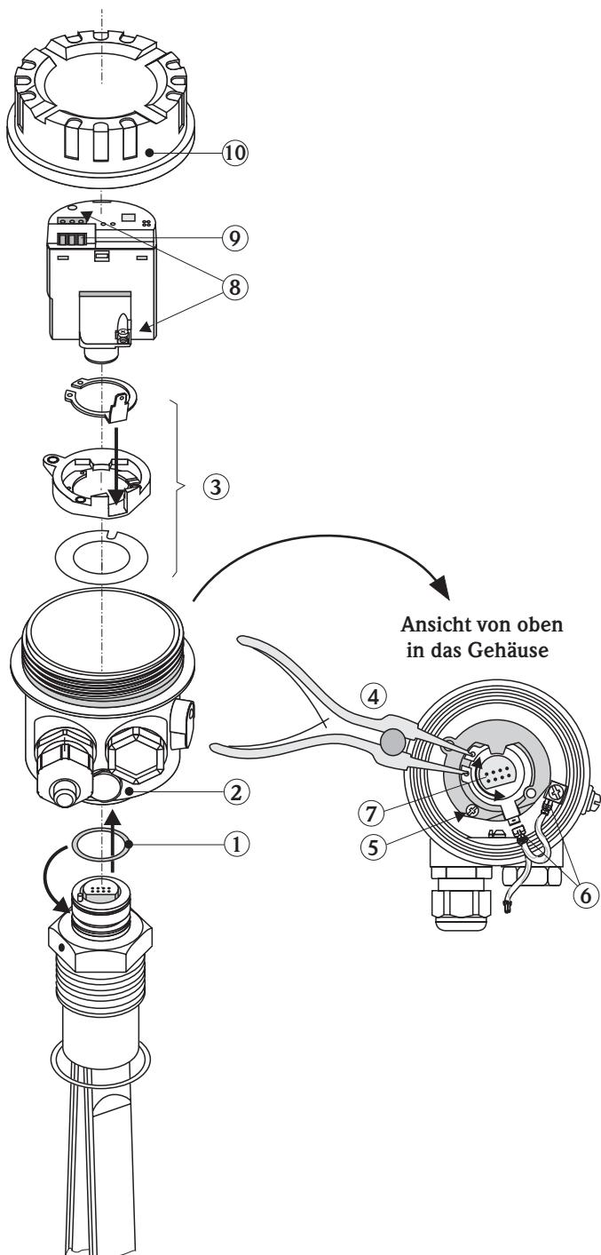
① O-Ring leicht einfetten und über den Sensorkopf schieben, siehe Abbildung.
