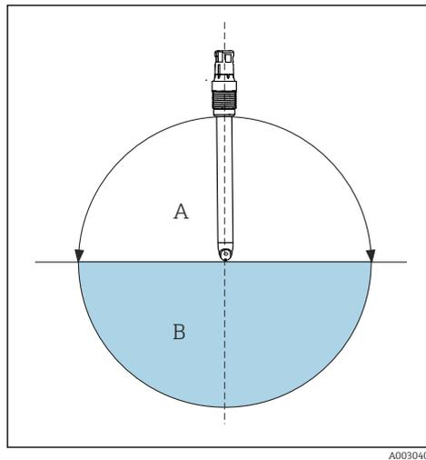
**i** Una volta installato, il sensore non deve rimanere a secco per più di 6 ore (anche in caso di installazione in posizione capovolta).
