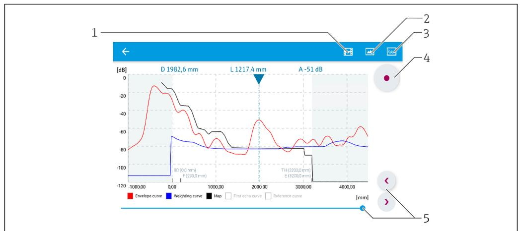
図 27 SmartBlue での反射波形表示 (例) ; Android の表示
