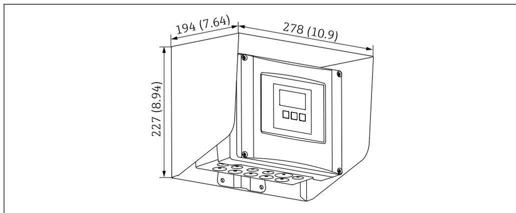
51 Tettuccio di protezione dalle intemperie per custodia da campo in policarbonato. Unità di misura mm (in)
