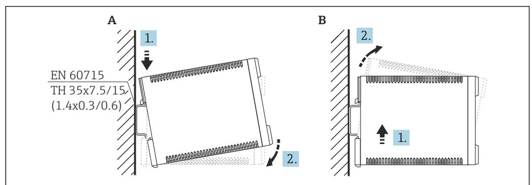
12 Montaggio/smontaggio della custodia su guida DIN. Unità di misura mm (in)
