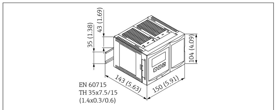
11 Dimensioni di Prosonic S con custodia per guida DIN. Unità di misura mm (in)
