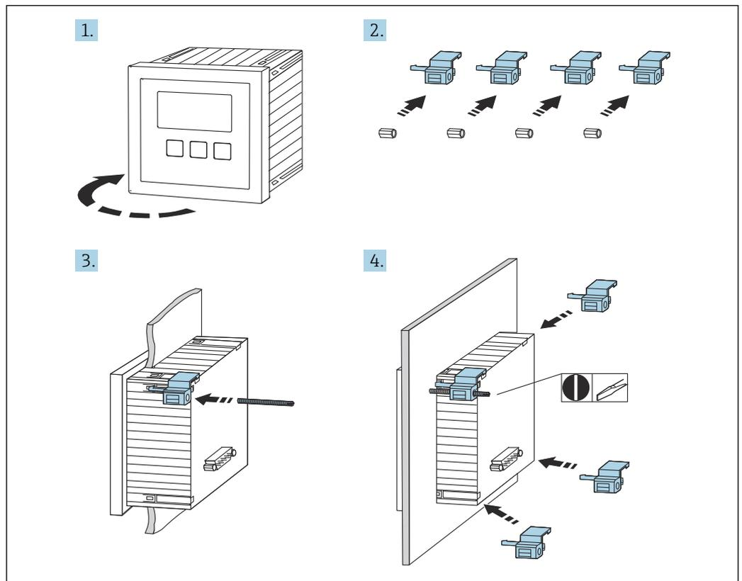
15 Installazione del display operativo e di visualizzazione separato
