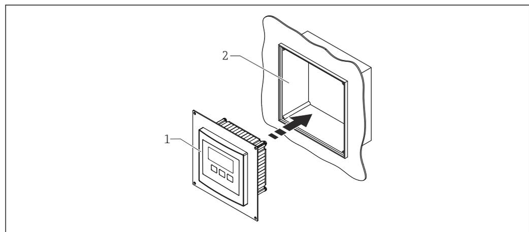
14 Montaggio nel display separato del dispositivo FMU860/861/862
