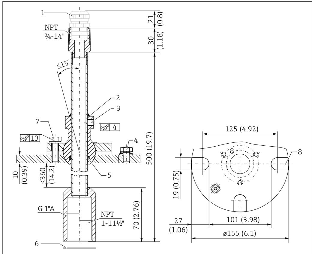
図 20 FAU40 角度調節器。測定単位 mm (in)
