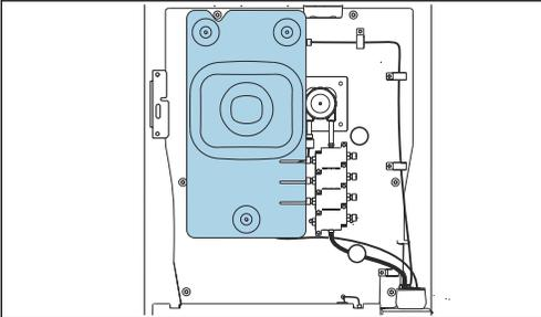
カバーのネジを緩めて、カバーを取り外します。
