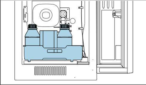
ボトルトレイを取り外します：凹型グリップをわずかに持ち上げ、正面方向に引きます。
