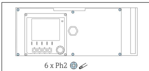
プラスドライバーを使用して、電子部カバーの6本のネジを緩め、カバーを正面方向に傾けます。
