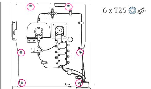
Torx ドライバー（T25）を使用してキャリヤボードのネジ 6 本を緩めます。
