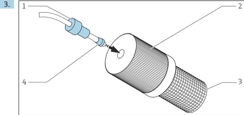
図 15 サンプルホースへの吸引ストレーナー（付属）の取付け
