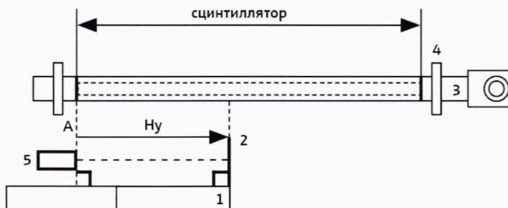
Рисунок А.2. - Схема измерения имитируемого пластинами уровня
