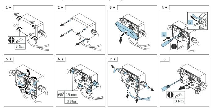
Die Montage erfolgt in umgekehrter Reihenfolge.
