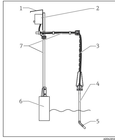
图 5 安装在立柱上的链条支座
