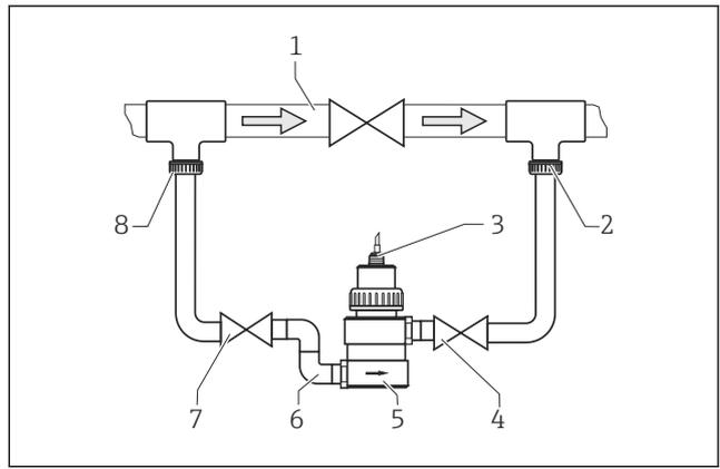
图 10 手动动作阀或电磁阀的旁路安装
