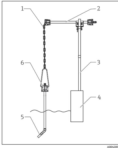
图 4 安装在护栏上的链条支座
