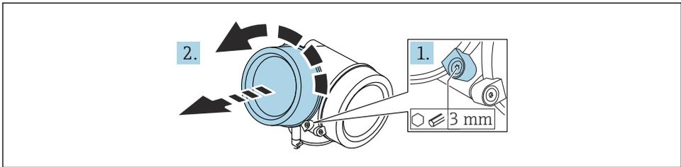
1. Schraube der Sicherungskralle des Elektronikumdeckels mit Innensechskantschlüssel (3 mm) lösen und Sicherungskralle um 90° gegen den Uhrzeigersinn schwenken.
