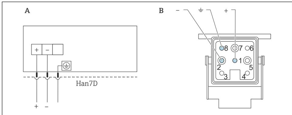
A Elektrischer Anschluss für Geräte mit Harting-Stecker Han7D
