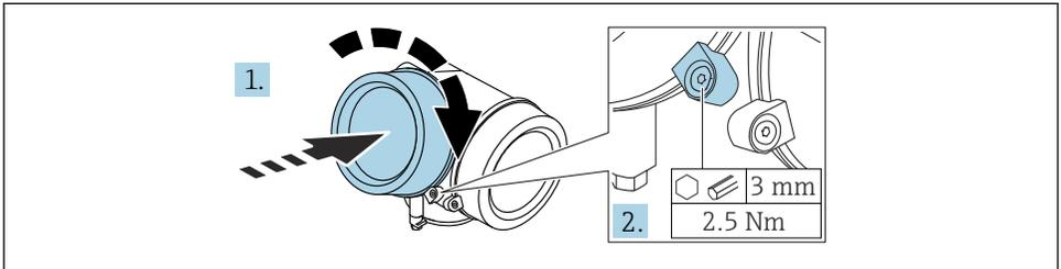
1. Avvitare il coperchio del vano dell'elettronica.
