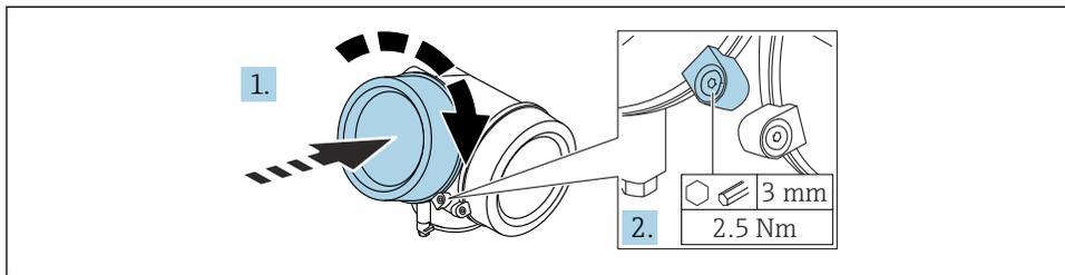
1. Aparafuse a tampa do compartimento dos componentes eletrônicos.
