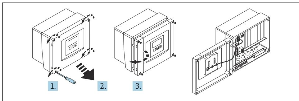
5 Acces la compartimentul cu borne din carcasa de teren din policarbonat
