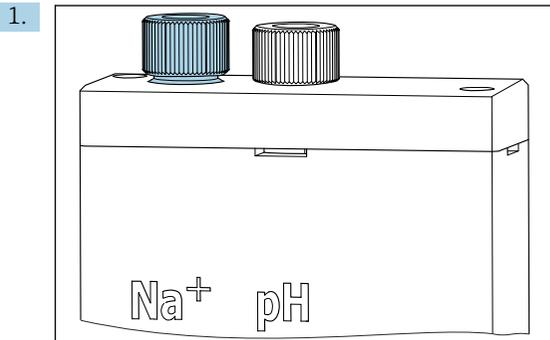
Verschraubung an der Messeinheit lockern.
