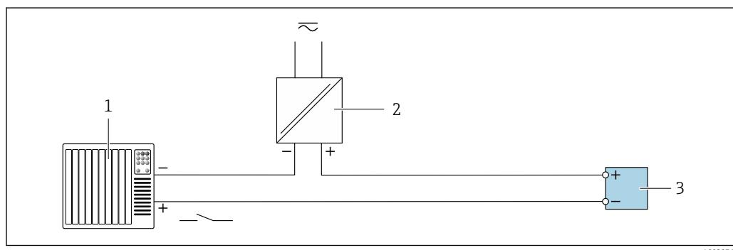
図 28 ステータス入力の接続例
