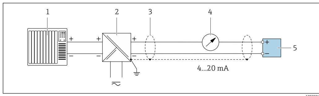
図 18 4～20 mA HART 電流出力（パッシブ）の接続例
