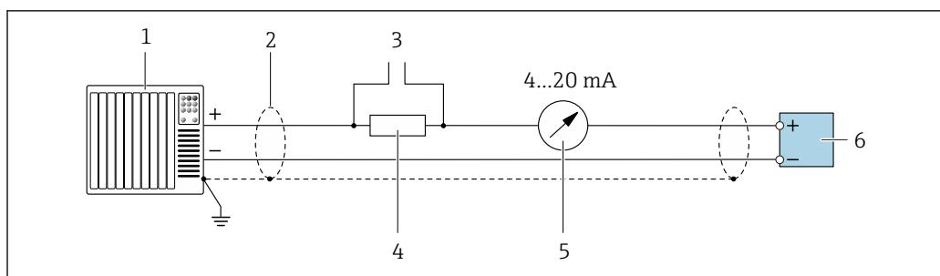
図 17 4~20 mA HART 電流出力（アクティブ）の接続例
