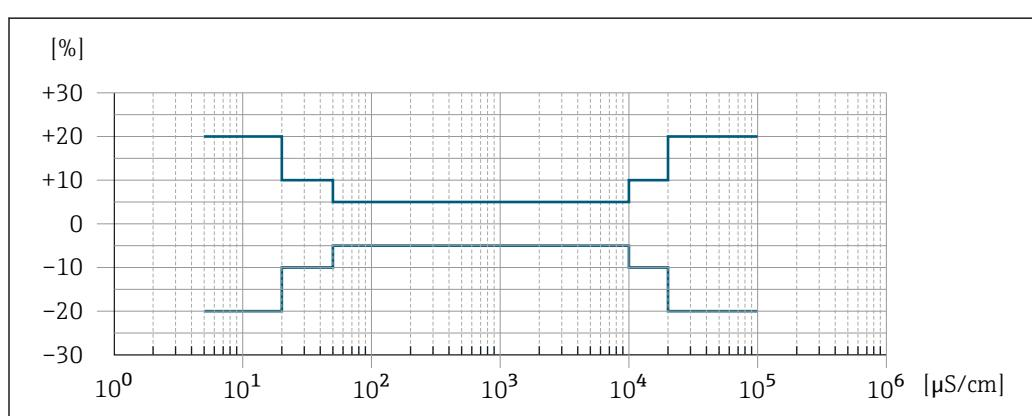
図 47 測定誤差 (オプション : 「校正された導電率測定」のオーダーコード、オプション CW)
