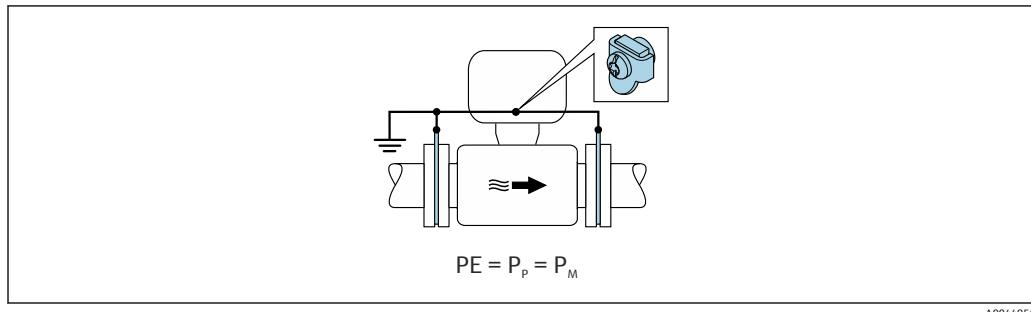
1. 接地ケーブルを介してアースリングを、変換器またはセンサ接続ハウジングの接地端子に接続します。
