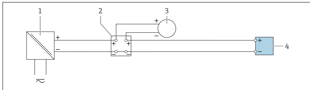
図 27 4~20 mA 電流入力の接続例
