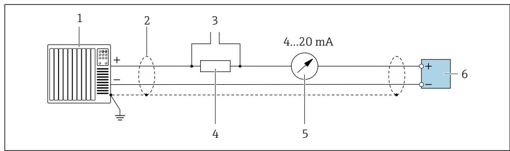
**2** Пример подключения токового выхода 4–20 mA HART (активного)
