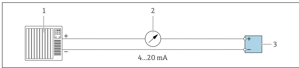
□ 13 Пример подключения для токового выхода 4–20 mA (активного)
