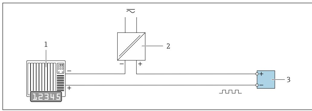
**■ 15 Пример подключения для импульсного/частотного выхода (пассивного)**
