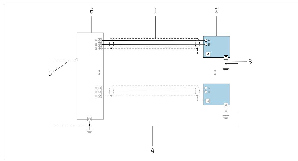
図 9 Пример подключения для интерфейса PROFINET с Ethernet-APL
