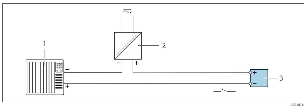
**■ 16 Пример подключения для релейного выхода (пассивного)**
