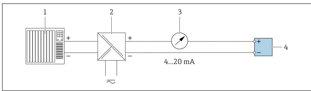
□ 14 Пример подключения для токового выхода 4–20 mA (пассивного)
