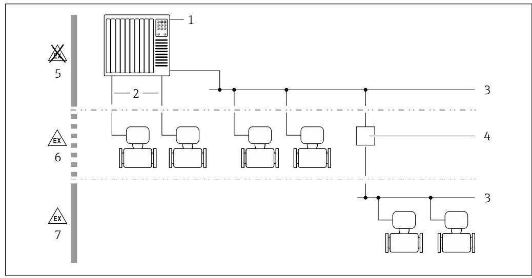
**■ 1 Возможности интегрирования измерительных приборов в систему**
