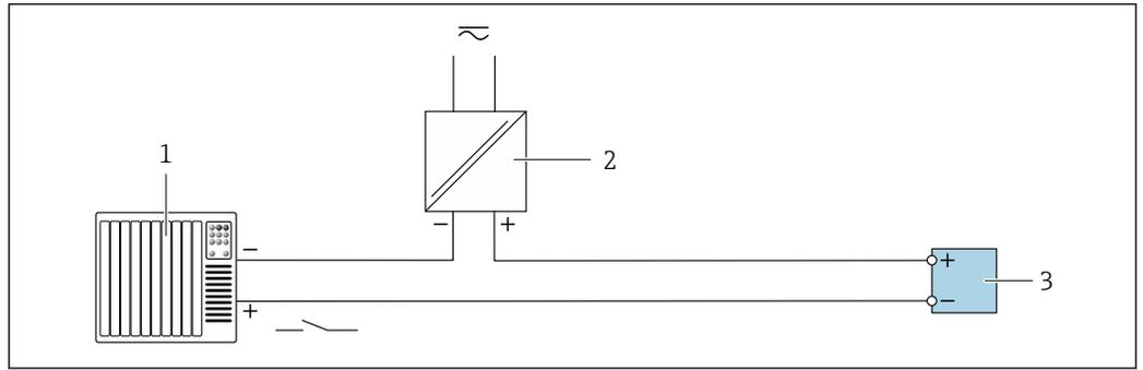
図 22 ステータス入力の接続例
