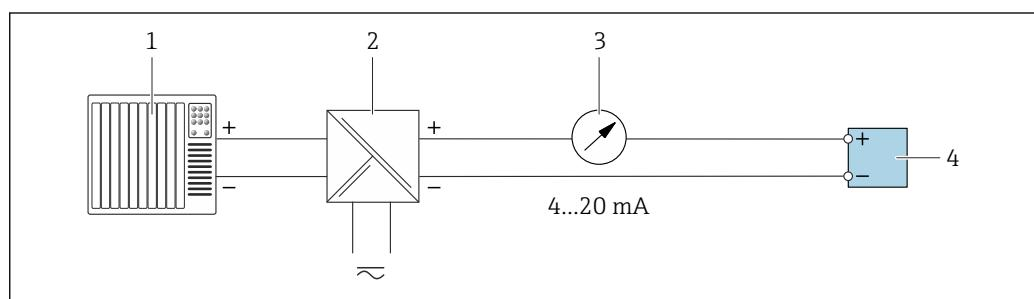
図 15 4~20 mA 電流出力（パッシブ）の接続例
