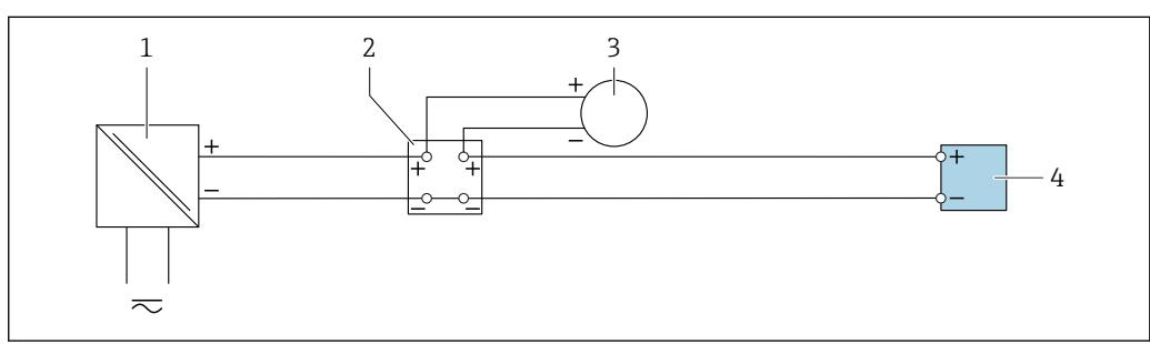
図 21 4~20 mA 電流入力の接続例
