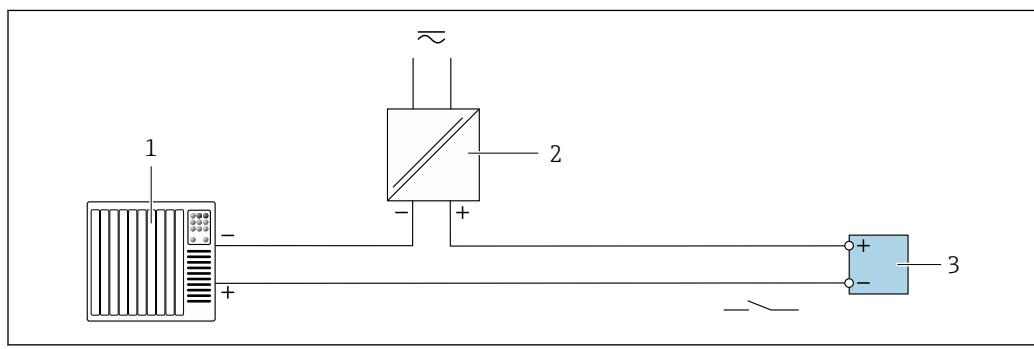
図 17 スイッチ出力（パッシブ）の接続例
