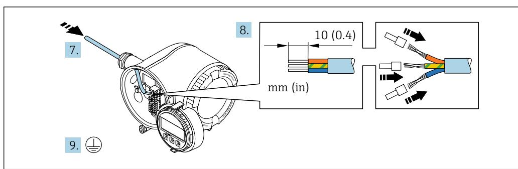
7. 電線管接続口からケーブルを挿入します。気密性を確保するため、電線管接続口のシールリングは外さないでください。
