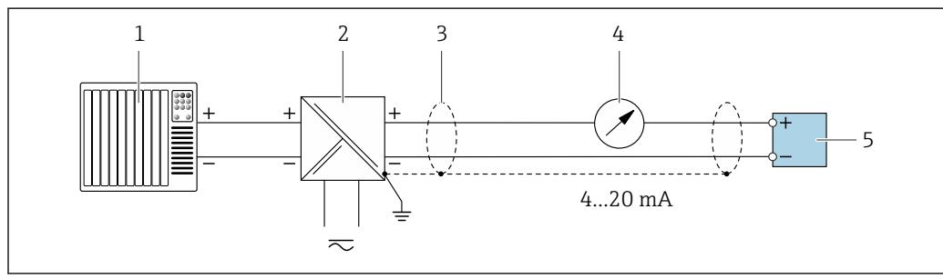
図 12 4~20 mA HART 電流出力（パッシブ）の接続例
