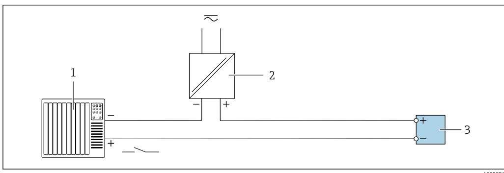
図 22 ステータス入力の接続例
