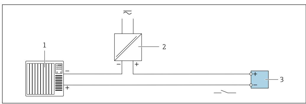
図 20 リレー出力（パッシブ）の接続例
