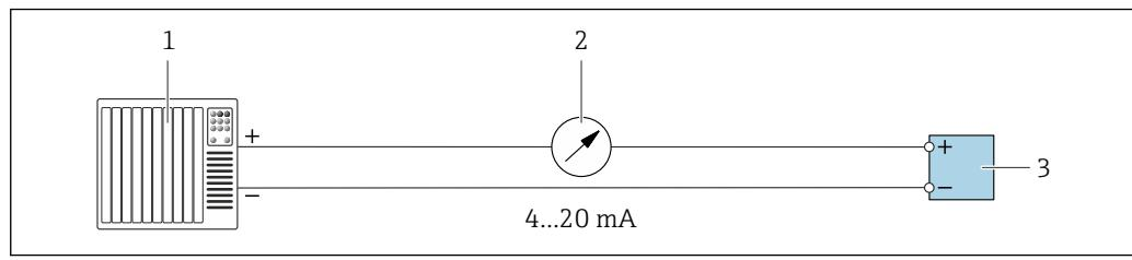
図 14 4~20 mA 電流出力（アクティブ）の接続例
