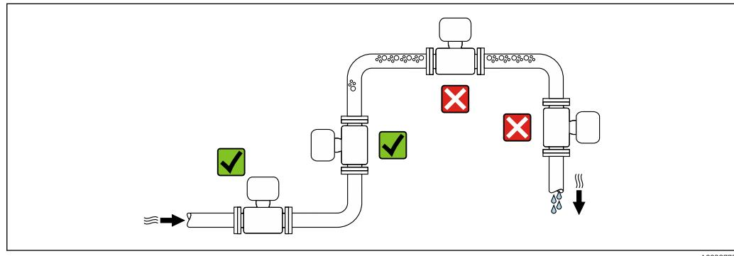
測定管内の気泡溜まりによる測定誤差を防止するため、以下の配管位置には取付けないでください。
