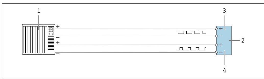
図 18 ダブルパルス出力（アクティブ）の接続例
