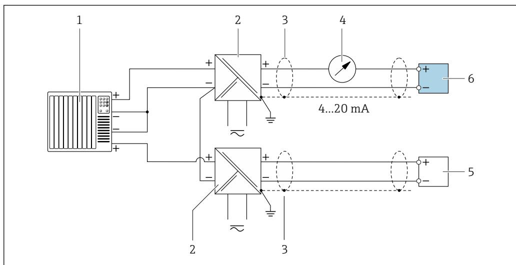
図 13 マイナスコモンの HART 入力（パッシブ）の接続例
