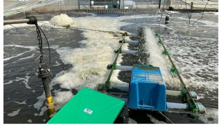
Endress+Hauser Sensoren mit Memosens-Technologie für gelösten Sauerstoff, pH und Salzgehalt, die zur Online-Überwachung der Wasserqualität in den Teich getaucht werden.
