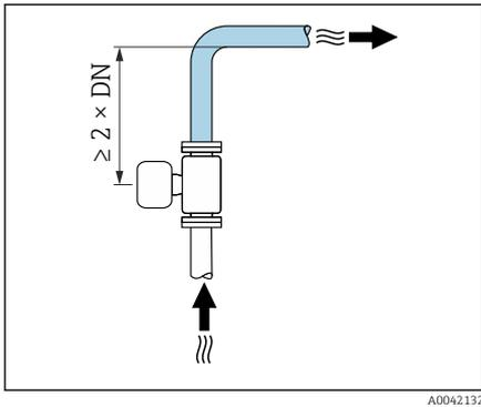
Mantenga una distancia suficiente hasta el siguiente codo de tubería.
