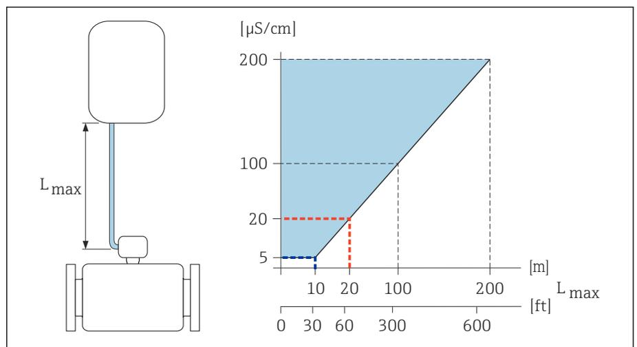
**4** Longitud permitida del cable de conexión
