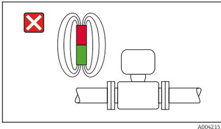
No instale el equipo cerca de campos magnéticos, p. ej. motores, bombas o transformadores.
