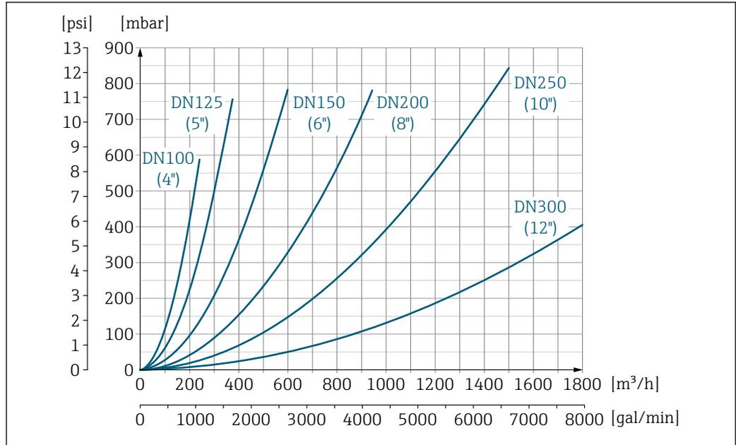
35 Pérdida de presión de DN 100 a 300 (de 4 a 12") para código de pedido para "Diseño", opción C "Brida fija, tubería de medición con contracción", 0 x DN tramos rectos de entrada/salida"
