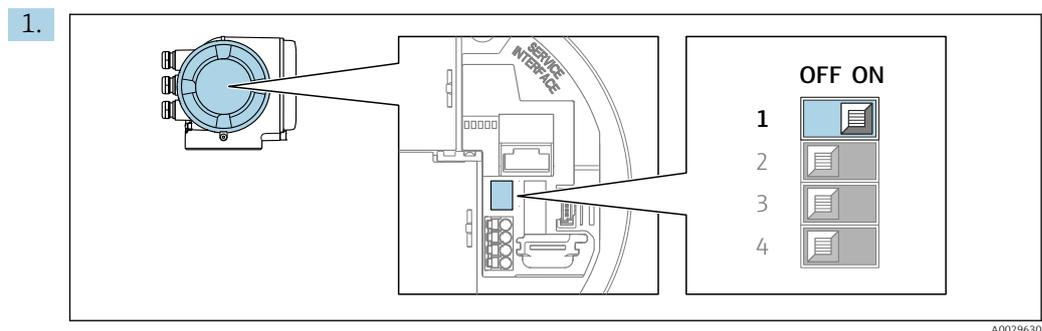
Al ajustar el microinterruptor WP del módulo de la electrónica principal en la posición **ON**, se desactiva la protección contra escritura.
