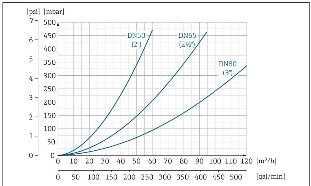
34 Pérdida de presión de DN 50 a 80 (de 2 a 3") para código de pedido para "Diseño", opción C "Brida fija, tubería de medición con contracción", 0 x DN tramos rectos de entrada/salida"
