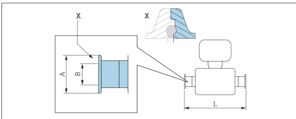
42 Detalhe X: conexão de processo assimétrica; a parte mostrada em cinza é proporcionada pelo fornecedor.
