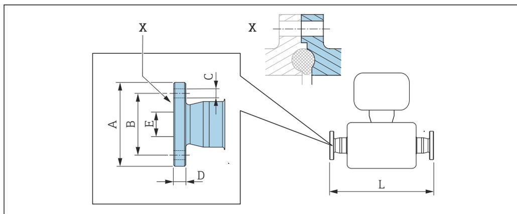
41 Detalhe X: conexão de processo assimétrica; a parte mostrada em cinza é proporcionada pelo fornecedor.
