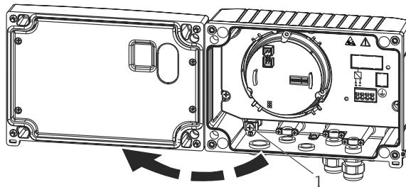
图 5 打开总线型数显仪外壳
