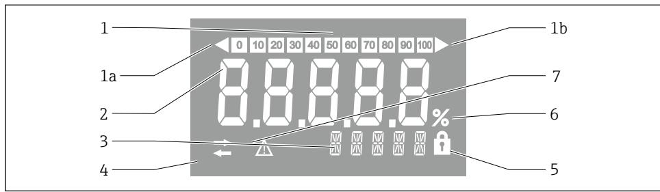
图 10 总线型数显仪的液晶显示屏
