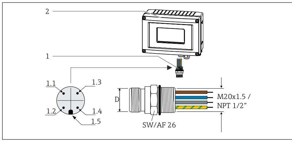
图 9 连接 PROFIBUS® PA 现场总线的连接头
