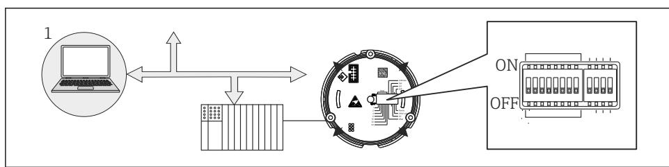
图 12 总线型数显仪的硬件设置
