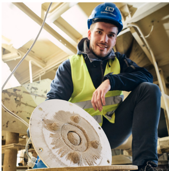
Ansatz an der Antenne ist eine Herausforderung und kann das Messergebnis beeinflussen
