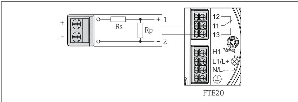
図 16 ライン監視用の抵抗回路（短絡および断線）
