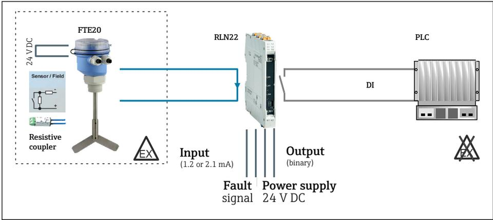
図 15 NAMUR リミット検知、FTE20 回転パドル式レベルリミットスイッチを使用した危険場所におけるライン監視
