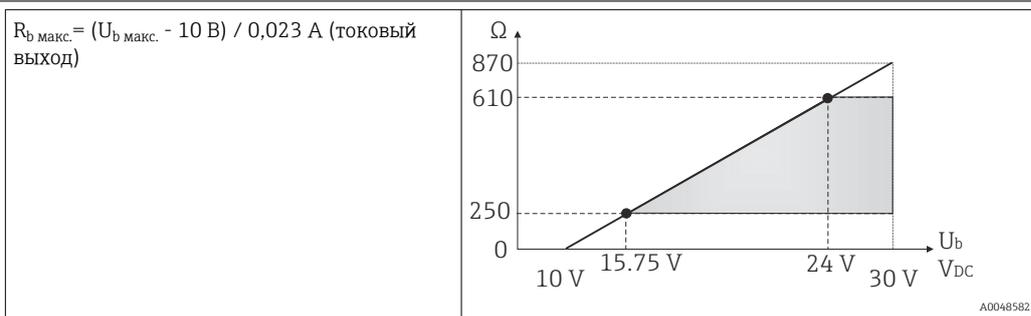
Поведение при передаче/линеаризации            Температура – линейная зависимость
