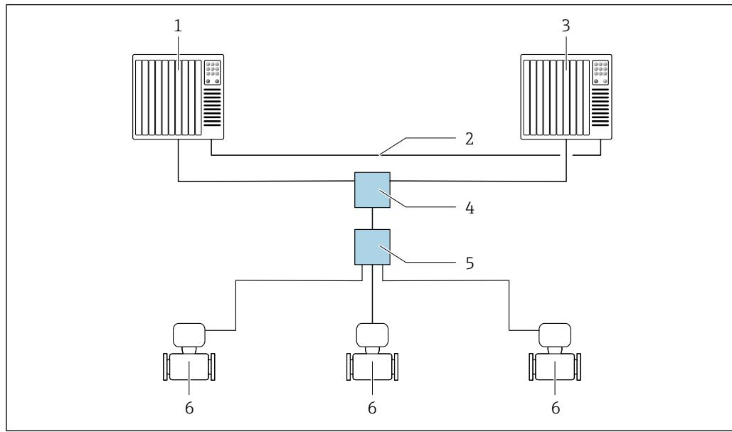
図 25 疋長システム (S2) のレイアウト例：スター型トポロジー
