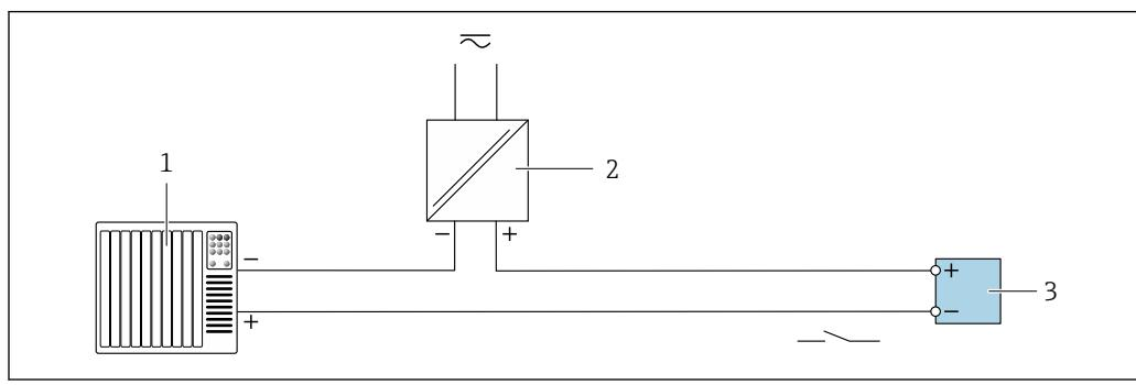
図 15 スイッチ出力 (パッシブ) の接続例
