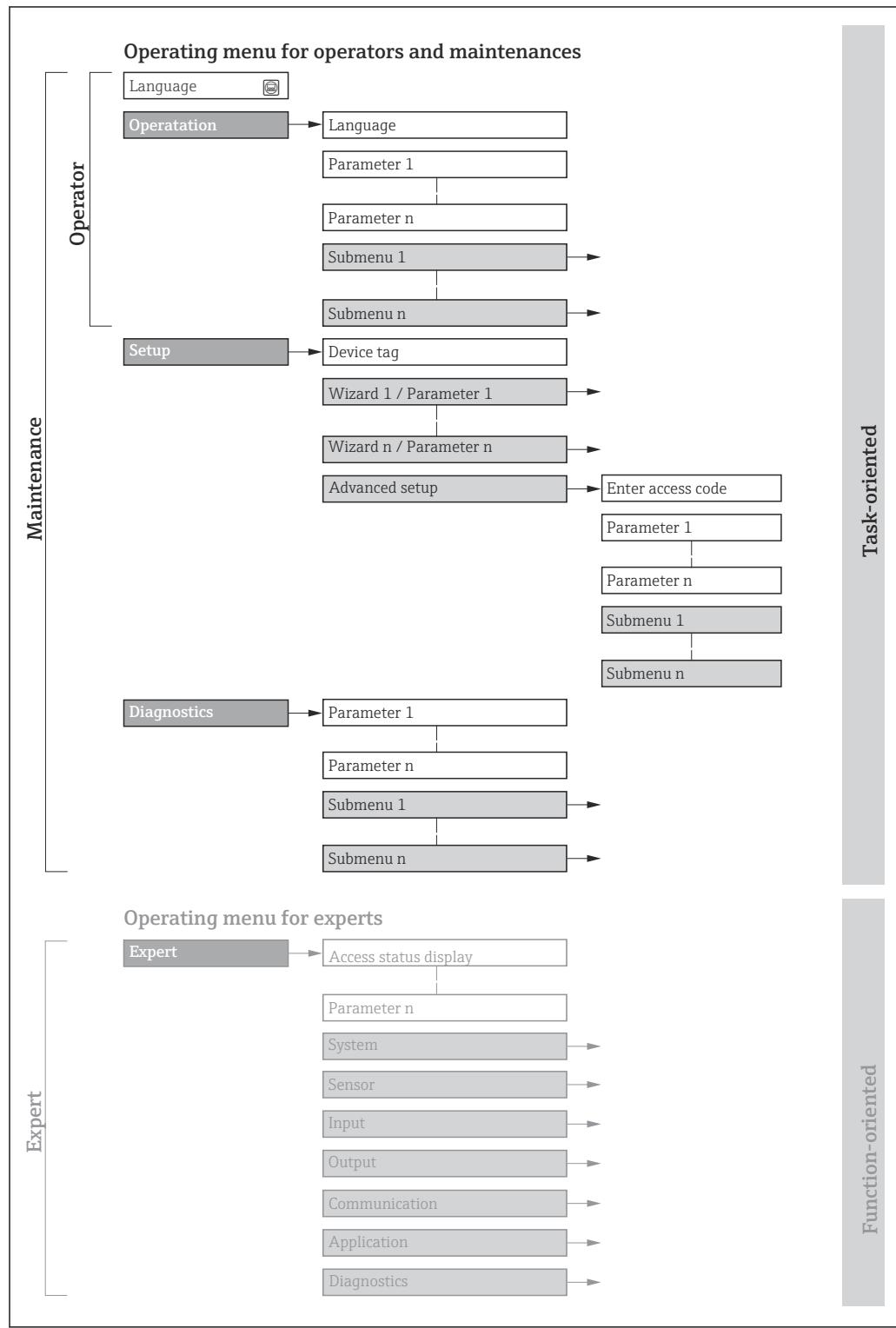
図 19 操作メニューの概要構成
