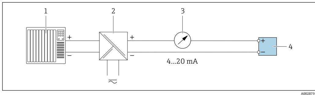
図 13 4~20 mA 電流出力 (パッシブ) の接続例
