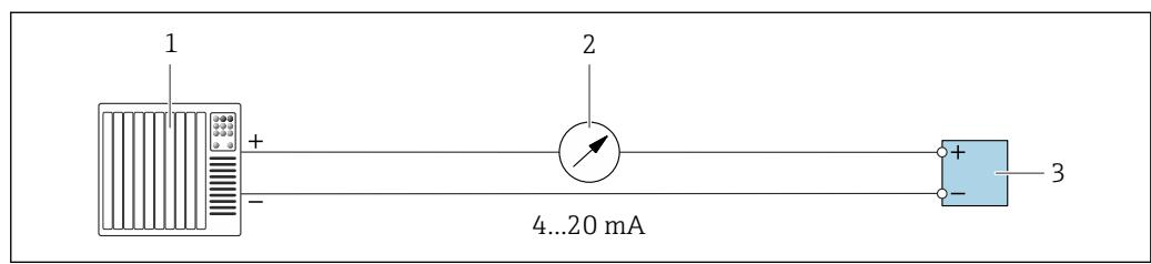
図 12 4~20 mA 電流出力 (アクティブ) の接続例
