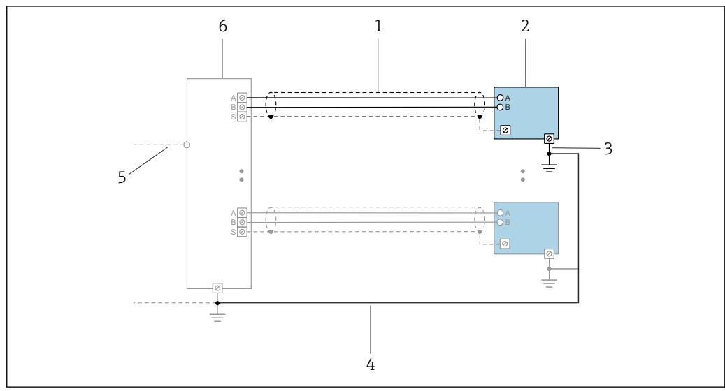
図 11 PROFINET (Ethernet-APL 対応) の接続例
