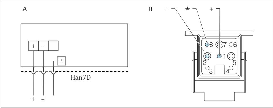
**A** Raccordement électrique pour les appareils avec connecteur Harting Han7D
