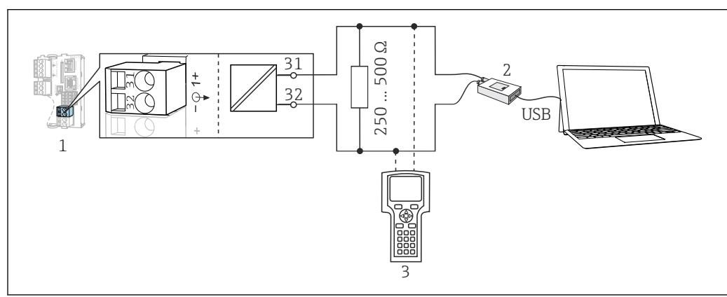
Figure 25 Передача данных по протоколу HART посредством модема
