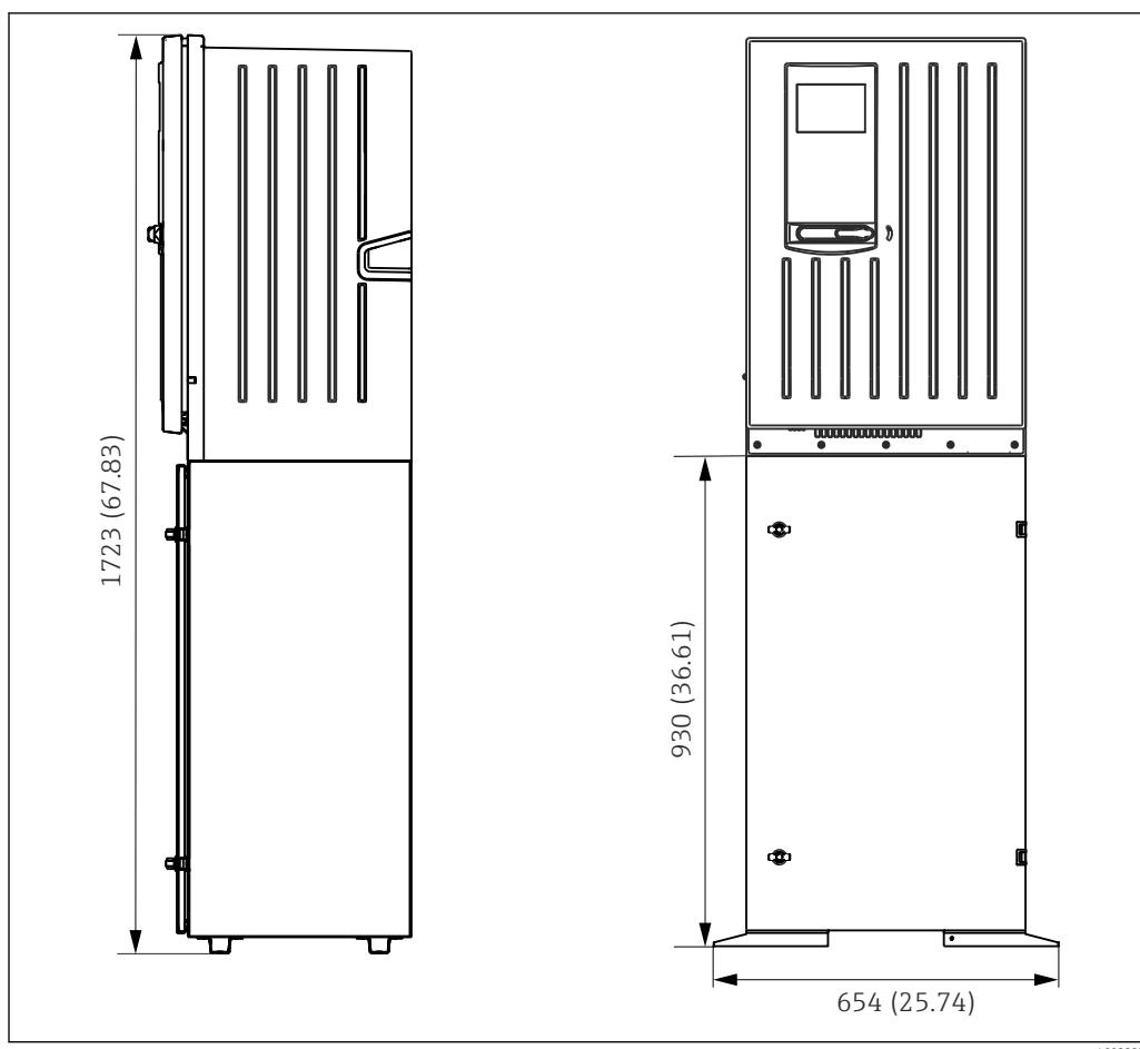
图 22 Liquiline System CA80 с опорой, размеры в мм (дюймах)
