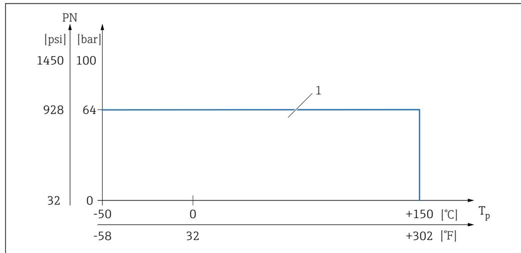
1 PN: 64 bar (928 psi) per un massimo di 150 °C (302 °F), per le eccezioni fare riferimento a "Conessioni al processo"
